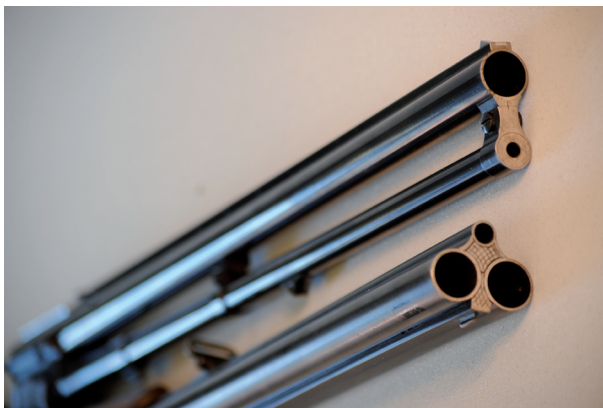
Ülal muudetavate raudade asendiga kombirelv. All joodetud raudadega drilling.
